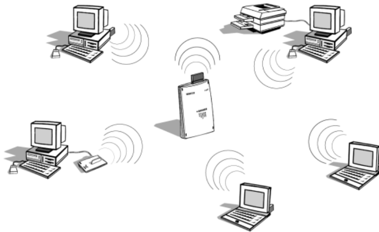
Bild 1.1 WLAN im Infrastruktur-Modus
