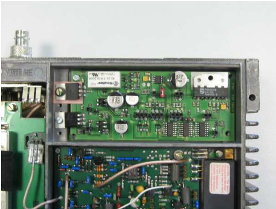
Bild: FUG 8 nach Einbau der Baugruppe
